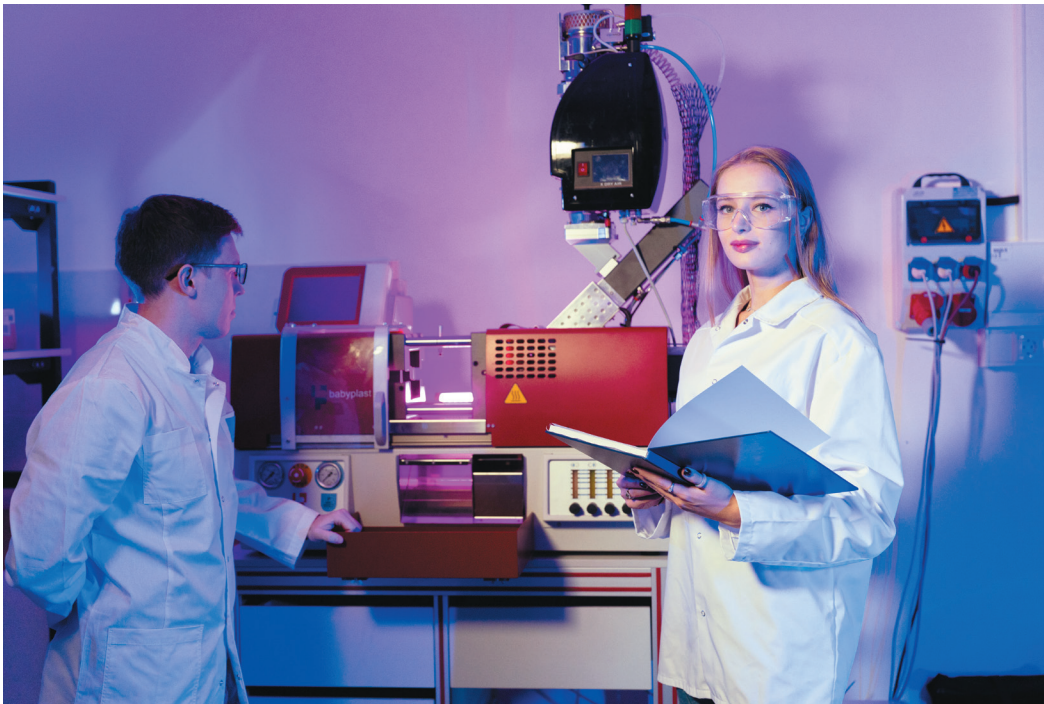
С помощью высокотехнологичных термопластавтоматов Центр может работать с широким спектром полимеров при температуре, порой превышающей 300 °С
